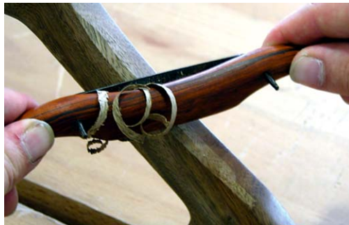
Ideal zur Bearbeitung gekrümmter Werkstücke: der chinesische Schweifhobel.
